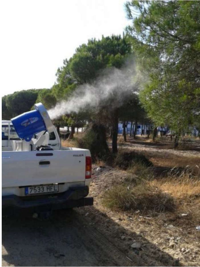
Fig. 4. Tratamiento contra mosquitos adultos en área peri-urbana mediante la técnica de Ultra Bajo Volumen
