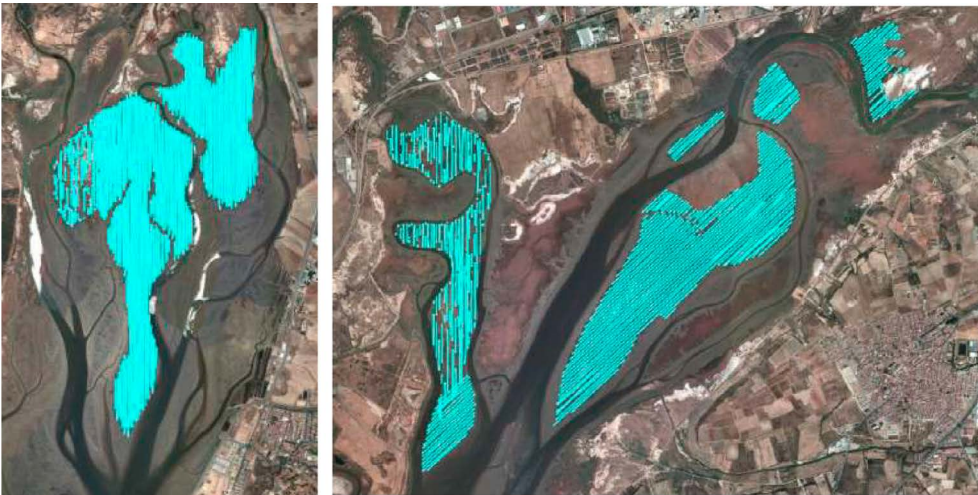
Fig. 19. Con trazos en color se muestran las pasadas realizadas por los aviones en tratamientos antilárvidos (Bti), obtenidas por los equipos DGPS en las marismas del Odiel (izqda.), y marismas del Tinto (drcha.).
