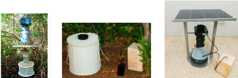
Fig. 32. Tipos de trampas para la captura de mosquitos; de izquierda a derecha: tipo CDC; tipo BG; y BG Counter; todas suplementadas con CO2.
